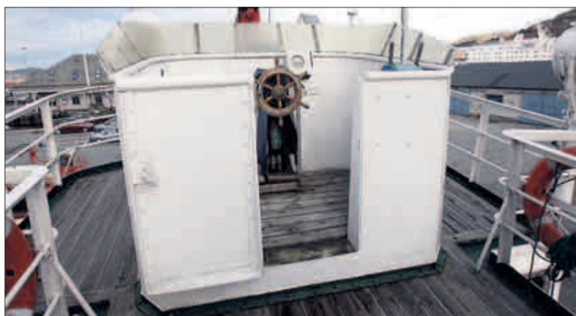
FLYBRIDGE: Styrehus på taket er kjekt å ha når oversikten innenfra ikke strekker til.
